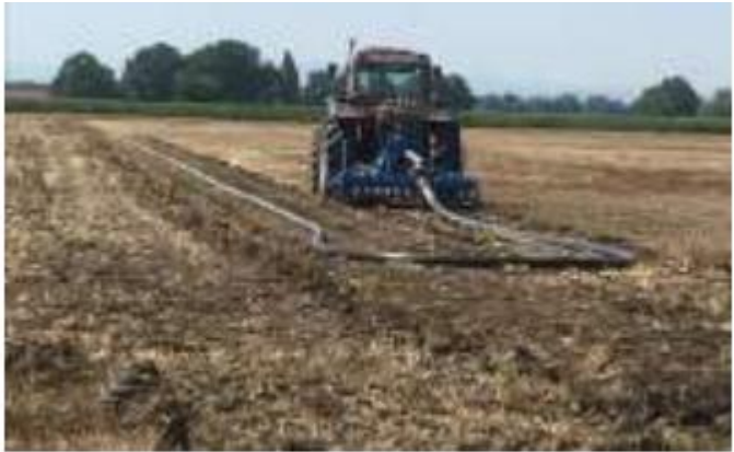
Figura 23 – Il sistema ombelicale consente di utilizzare la sola trattoria con un attrezzo portato per la distribuzione dei liquami evitando il compattamento del terreno.
