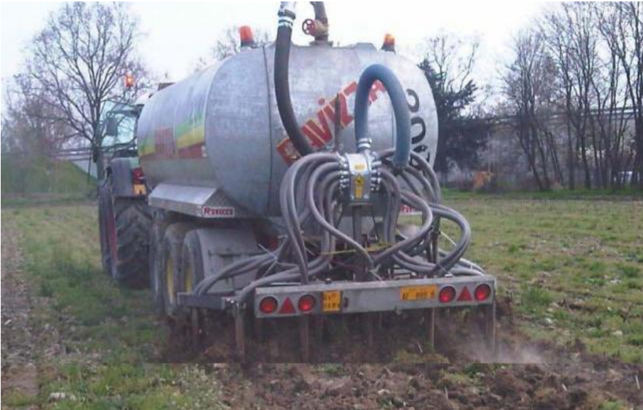
Figura 16 – Attrezzo per la distribuzione sotto-superficiale del liquame. L'incisione effettuata dai denti dell'erpice e di alcuni centimetri e il solco non viene chiuso.
